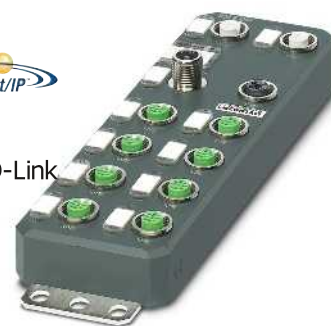
8 ports IO-Link, 4 entrées TOR
