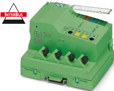
Raccordement par FO en biais, à 45°
