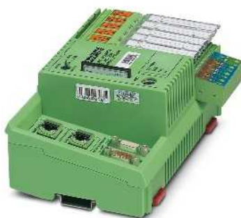
Commande compacte avec interface esclave INTERBUS
