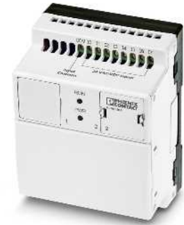
24 V DC, 8 entrées tout-ou-rien, 2 entrées analogiques et 4 sorties de relais
