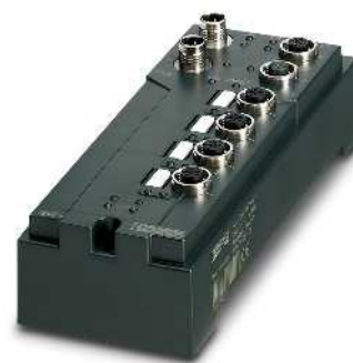
4 entrées de température pour capteurs résistifs
