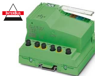
Raccordement par FO et bus interstation en dérivation par FO à 90°
