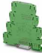
Relais statique de puissance avec sortie tension continue protégée contre les courts circuits, max. 10 A, avec signal de retour
