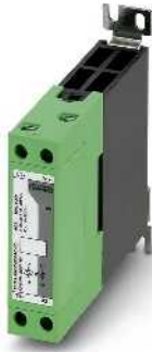
Pour la commutation de moteurs 1~ AC jusqu'à 660 V AC/30 A
