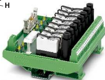
Module de sortie avec 8 relais miniatures, 1 contact inverseur et fusible pour chaque circuit de sortie
