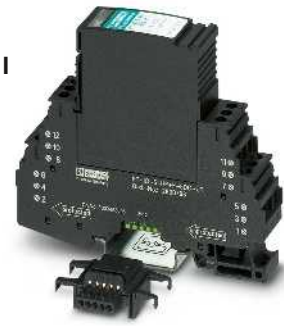
5 conducteurs avec potentiel de référence commun, raccordement 9/10 mis à la terre via un éclateur à gaz
