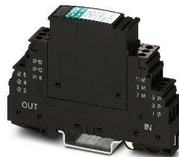
Parafoudre enchassable avec raccordement à vis, pour cinq fils, avec potentiel de référence commun
