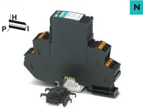
Paire de fils (boucle), indépendante du potentiel, raccordement 9/10 mis à la terre via éclateur à gaz
