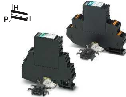
4 conducteurs avec potentiel de référence commun, raccordement 9/10 mis à la terre via éclateur à gaz
