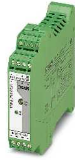
Convertisseur DC/DC, 12-24 V DC / 5-15 V DC, 2 A
