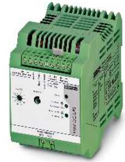
Alimentation secourue avec alimentation intégrée, 100-240 V AC / 12 V DC, 4 A
