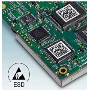
Repérage d'appareils à coller, pour applications ESD, pour impression avec la THERMOMARK ROLL... EML-ESD... Page 284
