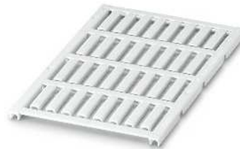
32 repères pour diamètre de conducteur de 2,9 à 3,6 mm, surface utile 21 x 4,5 mm
