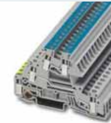
4 (4) mm 2 , 32 A, bloc de jonction à trois niveaux, 1 x phase L, 1 x N, 1 x PE
