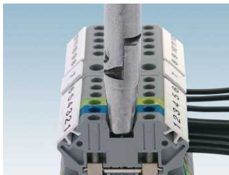
Éprouvette en forme de doigt Ø 12,5 mm
