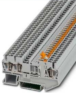
2,5 (4) mm 2 , 20 A, bloc de jonction à couteau de sectionnement, 3 raccords
