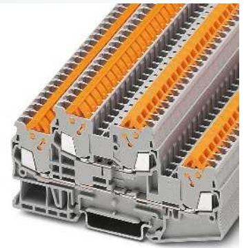
1,5 (1,5) mm 2 , 17,5 A, bloc de jonction à deux niveaux
