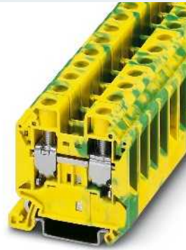
16 (25) mm 2 , 101 A, bloc de jonction pour conducteur de protection
