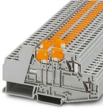
2,5 (4) mm 2 , 16 A, bloc de jonction à deux niveaux avec couteau de sectionnement pour chaque étage
