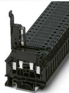
4 (6) mm 2 , 6,3 A, bloc de jonction-fusibles à levier, pour fusibles G 5 x 20 mm
