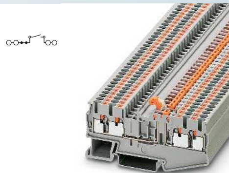
2,5 (4) mm 2 , 20 A, bloc de jonction à couteau de sectionnement, 4 raccords
