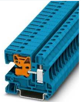
10 (16) mm 2 , 57 A, bloc de jonction de sectionnement de N
