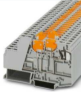
2,5 (4) mm 2 , 16 A, bloc de jonction de traversée, 3 raccordements, avec deux couteaux de sectionnement
