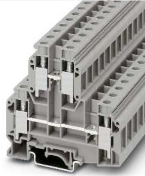
10 (16) mm 2 , 76 A, bloc de jonction à deux niveaux
