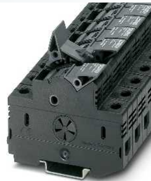
16 (25) mm 2 , 32 A, bloc de jonction-fusibles à levier pour fusibles Midget 10,3 x 38 mm
