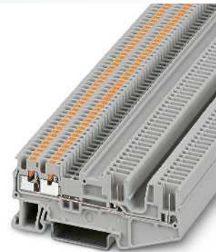
1,5 (1,5) mm 2 , 13,5 A, bloc de jonction de traversée, 4 raccordements
