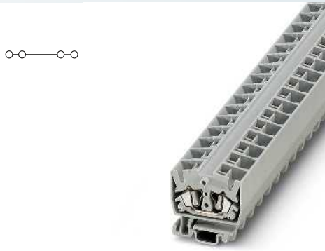
2,5 (4) mm 2 , 30 A, bloc de jonction de traversée, 4 raccordements
