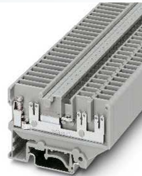
4 (4) mm 2 , 32 A, bloc de jonction de traversée, avec raccordement vissé et par clip
