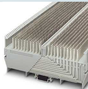
5 A, bloc de jonction répartiteur, 10 étages avec raccordement TP
