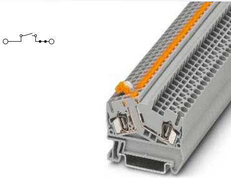
2,5 (4) mm 2 , 20 A, bloc de jonction à couteau de sectionnement
