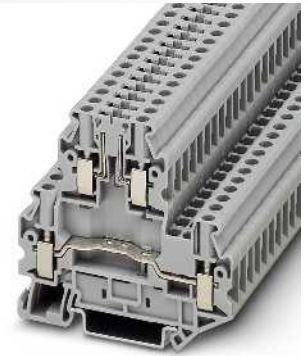
4 (6) mm 2 , 20 A, bloc de jonction à deux niveaux avec zone de sectionnement
