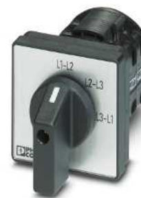
2,5 (2,5) mm 2 , 20 A, commutateur inverseur-voltmètre sans position 0
