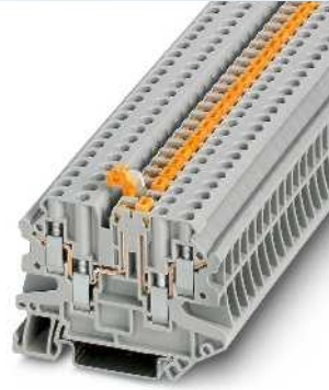
4 (6) mm 2 , 20 A, bloc de jonction à couteau de sectionnement, 4 raccords
