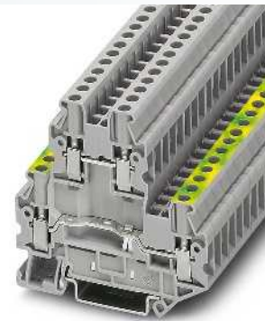
2,5 (4) mm 2 , 28 A, bloc de jonction à deux niveaux pour conducteur de protection
