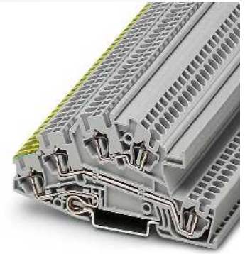
2,5 (4) mm 2 , 24 A, bloc de jonction à trois niveaux, 2 x phase L, 1 x PE
