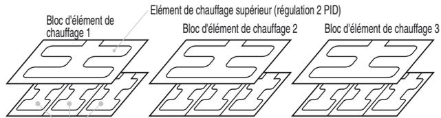
Elément de chauffage inférieur (régulation de la température par gradient exécutée pour trois éléments de chauffage)
