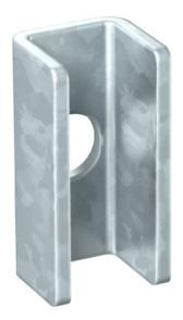
Pour des raisons de statique, l'entretoise est toujours utilisé pour prévenir le profil de se déformer lorsque les boulons de fixation sont bien serrés.
