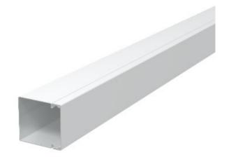
Trunking couvercle et la base avec la base de perforation. Liaison équipotentielle est garanti entre le couvercle et la base, sans aides supplémentaires. Remarque: LKM 60060 a pas de boucle de perforation dans la base, une partition ne peut pas être installé.
