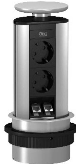
Lowerable Deskbox avec câble de raccordement pour une installation fixe sur une table, en plastique de fixation de manches, peint en conséquence dans la couleur de la table. Il est monté à l'aide d'un trou de forage (Ø102 mm) dans la table.
