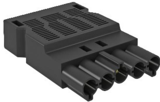
Élément de connecteur, 5 broches, type GST18i, avec connexion à vis 1,5–2,5 mm<sup>2</sup> câbles, simples et beaux-fils, avec décharge de traction, une connexion par code pin, non montés, pour câble H05VV (Ø 9,5–13.5) NYM et (Ø 10,5–13,5 mm), verrouillable, selon la souche de secours dans VDE 0628 un cadenas doit être prévu, 250 V, 16 A.
