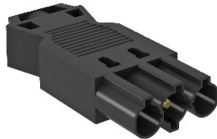
Élément de connecteur, 3 pôles, type de GST18i avec connexion à vis, de faible hauteur (pas de fente de perte en combinaison avec le distributeur blocs), pour les sections transversales de 0,75-2,5 mm<sup>2</sup>, simples et beaux-fils des câbles connectable sans manchon d'extrémité, pour des diamètres de câble entre 6,5-10,5 mm (H05VV, NYM), démonté avec décharge de traction, résiliable in situ, 250 V, 16 A.
