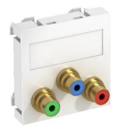
La prise en charge multimédia avec trois prises cinch vidéo composant, tout droit sortie de câble, de l'étiquetage, trois cinch accouplements (RCA), socket, socket version, les codes de couleur rouge / vert / bleu. Support de plaque avec verrouillage de la fixation, approprié pour l'installation horizontale et verticale dans l'environnement du système.
