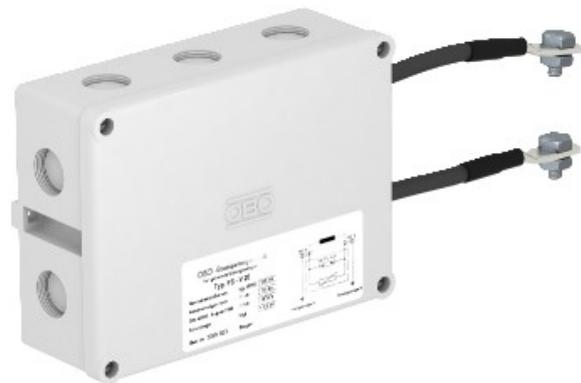
Le FS-V 20 appareil est une décharge écart avec les connectés en parallèle de surtension tension de protection. Il est utilisé pour coupler les différents systèmes de mise à terre. Il est directement relié à la liaison équipotentielle ferroviaire concernée.
