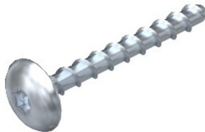
Protection contre l'incendie boulon de serrage avec grand pan de la tête pour le montage direct sans complément d'ancres. Lecteur T30, trou de perçage de 6 mm. Protection contre l'incendie testés selon la norme DIN 4102 pour le béton et la maçonnerie.
