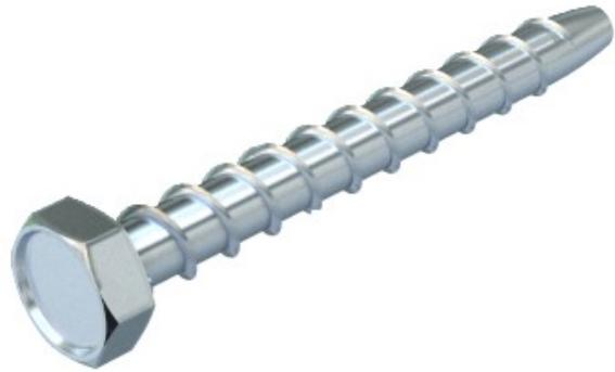
Protection contre l'incendie béton boulon à tête à six pans pour montage direct sans point d'ancrage supplémentaire. WAF 16. Trou de perçage de 8 mm. Protection contre l'incendie testés selon la norme DIN 4102 pour le béton et la maçonnerie. Classe de résistance au feu pour F90.
