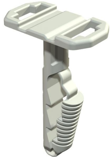
Le push-fit d'ancrage peut accepter une attache de câble (type 550 555) jusqu'à 9 mm de large, qui peut être utilisé pour installer plusieurs câbles et de tuyaux. Convient pour le béton, chaux, de sable et de maçonnerie, de briques solides. Utiliser de l'essence de maçonnerie en béton est possible, mais a réduit les capacités de charge doit être prévu.
