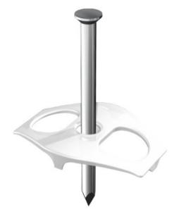
Avec pré-monté, en acier galvanisé clou Ø 3 mm ou 3,5 mm pour fixer les câbles dans la maçonnerie, les fentes et sur la maçonnerie, pour un ou deux câbles NYM 3 x 1,5/2,5 mm2 ou d'un ou deux câbles NYM 5 x 1,5/2,5 mm2.
