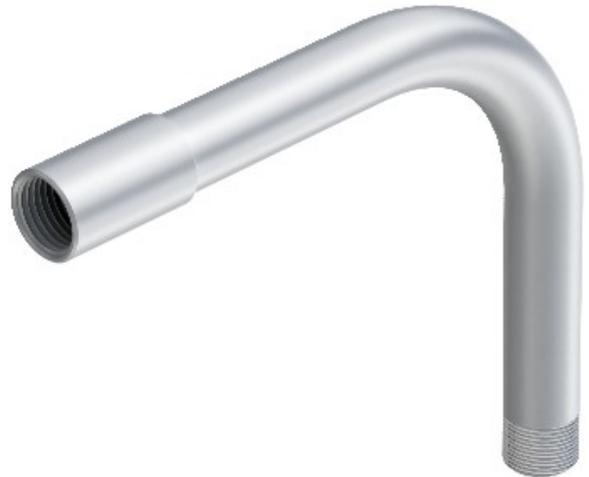
Coude à 90° pour l'installation électrique des tuyaux selon la norme EN 61386-1 avec extrémités filetées DIN EN 60423. Avec sans bavure à la paroi intérieure.
