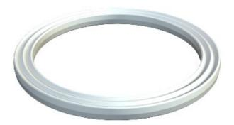
Filetage de connexion bague d'étanchéité, conformément à la Partie 9 de la norme DIN 46320, cependant, les dimensions peuvent, en fonction du matériau ou de la fonction, s'écarter, convient pour tous les presse-étoupe en plastique avec PG filetage de connexion DIN 40430, le diamètre intérieur des bagues d'étanchéité sont conçus de sorte qu'ils peuvent être captively pré-monté.
