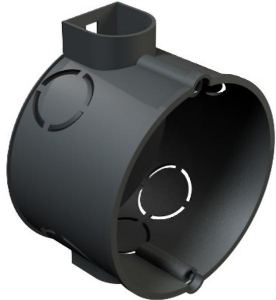
La prise accessoire avec résistant à la torsion de la garantie standard de la combinaison de l'espacement de 71 mm (DIN 49 073-1) par snap-lock de couplage. 7 Break-out ouvertures pour les câbles et les tuyaux de Ø 20 mm et Ø 25 mm. Peut être combiné pour la propagation et de la vis de fixation, bas-pose de plâtre titulaires, d'un dispositif à vis de l'espacement de 60 mm, pour vis de fixation avec les vis auto-taraudeuses de 3,2 mm, avec deux vis de dômes sans vis, indice de protection IP20.
