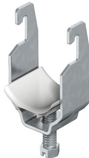
Convient pour tous les C profil des rails avec fente de largeur 18 mm et 22 mm. Également adapté pour la télévision, de l'angle et de U en acier de 4 - 12 mm d'épaisseur. BBS de serrage de boulon et fait des galvanisé à chaud de l'acier. Polypropylène pression manches, sans halogène, couleur gris clair RAL 7035.
