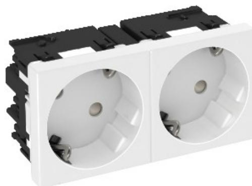
Prise de courant à côté de connexion double 33°, avec l'augmentation de la protection contre le toucher avec bornes sans vis, 2 broches, 16 A, 250 V~, avec bornes de raccordement à la norme IEC 60884-1.
