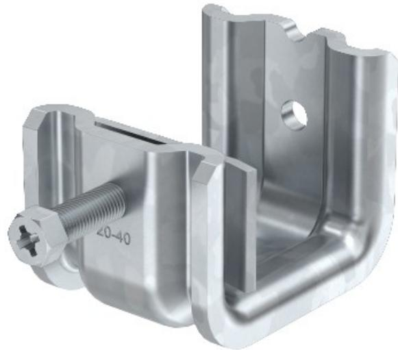
Ce type de faisceau pince est poussé sur le support et fixé à la poutre ou fer plat à l'aide d'une pression de l'auge et de boulons (M8). Le boulon hexagonal a un WAF de 10 mm. Dans le clip de l'élément, les deux autres filets M6 sont également intégrées, pour fixer les tiges filetées, par exemple.
