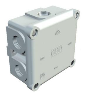
Indice de Protection IP54, tension nominale 660 V nominal de section 2,5 - 4, en combinaison avec la mise à la terre du terminal de 700/6 M, la zone a de la valeur nominale de la croix-section 4 mm2, deux trous de fixation pour vis de 5 mm  $\emptyset$  sur le côté extérieur de la boîte. Quatre couvrir les couvercles, 7 break-out entrées avec filetage M20 x 1,5, principalement pour les presse-étoupes avec court de fil conducteur.
