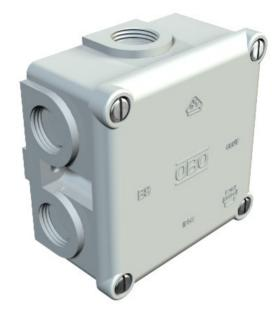
Indice de Protection IP54, tension nominale 660 V nominal de section 2,5 mm2, deux trous de fixation pour vis jusqu'à 5 mm de  $\emptyset$  sur l'extérieur de la boîte, les quatre boulons du couvercle, 7 break-out entrées avec filetage M20 x 1,5, principalement pour les presse-étoupes avec court de fil conducteur.
