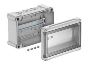
Monté en Surface de la boîte de distribution, avec isolation de protection pour max. 12 division des parts. Il y a 11 break-out ouvertures (10x Ø20 et 1x Ø20/25/32) à la fois sur les côtés supérieur et inférieur, incl. pré-monté de 35 mm profilé rail de support. Les quatre vis des couvercles fournis éviter les "tension report".
