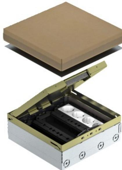
Place de la boîte au sol pour une utilisation dans le nettoyage à sec de la cavité et de la chape. Installation du boîtier avec pré-a marqué l'insertion des ouvertures pour les pipelines (M25). Couverture ajustable pour le bord supérieur du revêtement de sol à l'aide de quatre réglage de la hauteur des supports. L'installation minimale profondeur est de 95 mm, hauteur plage de réglage de + 30 mm.
