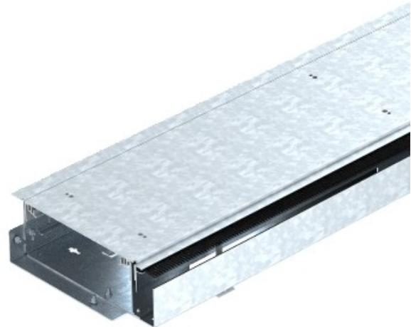
Prêt-à-monter gaine pour câble de routage et d'installation de l'appareil, constitué d'une gaine à la base avec deux couvercles et réglable en hauteur barre de brosse et d'un revêtement de sol profil de contact. La livraison contient deux couvercle joints bout à bout et d'un connecteur.
