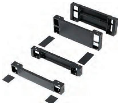
**Description:** Panneaux avant et arrière de socle. Pour câblage sans restriction et suivant standard VDE0113. Le socle consiste en 4 coins et panneaux de fermeture amovibles. Les panneaux latéraux PS sont à commander séparément. Existent en 100 et 200mm de hauteur. Les socles de 200mm sont livrés avec à l'arrière 2 panneaux de 100mm tandis que le panneau avant est d'une seule pièce. Chaque panneau a un double pli pour augmenter la rigidité.
