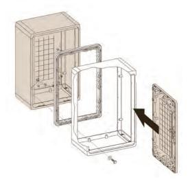
Description: Accroît la profondeur standard de l' armoire de 320 mm à 640 mm. Avec cet accessoire, le toit ne peut être utilisé.
