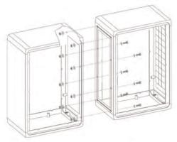
Description: Kit permettant I' accouplement vertical et/ou latéralUsinagenécessaire.
