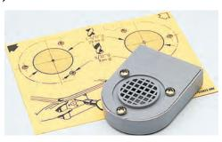
Description: Il convient d'installer deux bouches d'aération par armoire afin d' assurer une circulation d' air suffisante et d' éviter la condensation. Les bouches d'aération seront installées de préférence sur les parties supérieure et inférieure de l'armoire. Degré de protection : IP 44.
