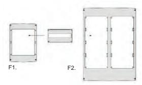
Description: Cadre à recouvrir de plaques d' obturation individuelles UICP. Avec deux colonnes pour les armoires de
