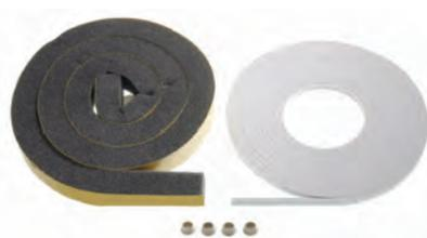
**Description:** Le fond de l' armoire est rendu étanche par un joint adhésif placé sur le cadre, autour des ouvertures inférieures. L' étanchéité peut être augmentée par un joint mousse adhésif placé entre les plaques enserrant les câbles. L' élasticité et la taille de ce joint assurent l' étanchéité hermétique autour de la plupart des câbles.
