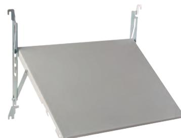
**Description:** Montée directement sur le cadre de porte, la tablette permet d' aménager une surface de travail stable pour y poser les documents, l' ordinateur ou les appareils de mesure. La tablette est facilement escamotable. Elle peut être fermée et s' intégrer dans l' alignement du cadre de porte. Le positionnement se fait automatiquement à 55, 70 ou 90 degrés. La DDK 800 peut-être montée sur une porte de 1000mm de large en utilisant l' accessoire DCP1002.
