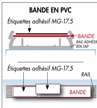
Les bandes de repérage sont idéales pour aligner les étiquettes des composants modulaires MG-17,5 ou sont appliquées sur les tableaux jusqu'à 430 mm, directement sur la tôle ou sur un rail adapté aux dimensions.
