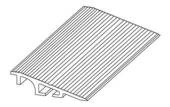
Bord garni de profil pour éliminer les bords verticaux sur le tapis de sécurité. Principalement pour DEMANDEZ-1U4 modèle.
