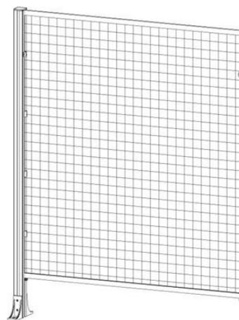
Rapide-Garde de la section E avec un 44x44mm profil et Polycarbonate 1074x1216mm. Hauteur totale 1400 mm, largeur 1100 mm c-c profils.
