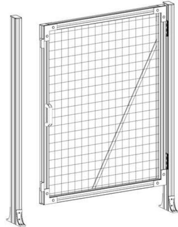
Quick-Guard E porte l'article avec 44x44/44x88mm profils. Y compris les composants des profils, des fixations, netlocks, pré-monté doorleaf avec treillis soudés. Hauteur totale 1400 mm, largeur 1100 mm c-c profils.
