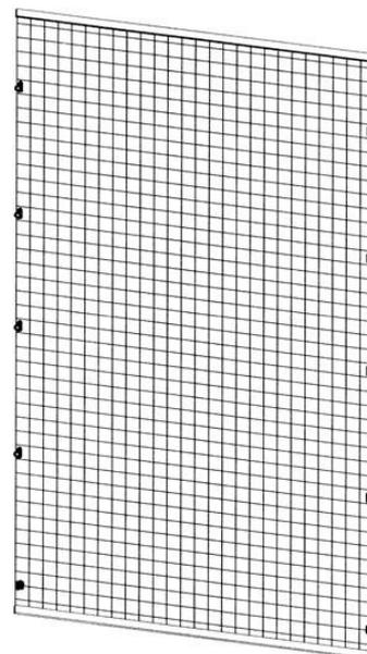
Rapide-Garde de la section E sans profils. Y compris les composants en maille soudée, polycarbonate, netlocks et de protection de bord. Hauteur totale 2000 mm, largeur 1100 mm c-c profils.
