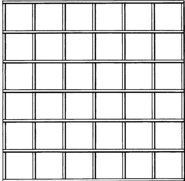
soudés steelmesh 40x40x3,5mm enduit de poudre en noir dimension 1474x1816mm
