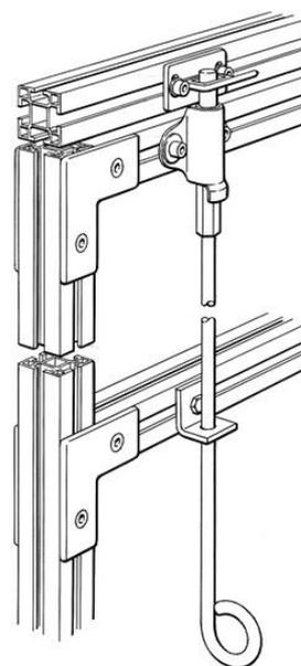
Ressort pullock pour au-dessus de la porte. Les crochets sont en acier zingué, Tige en acier Inox. Hauteur totale 1130mm
