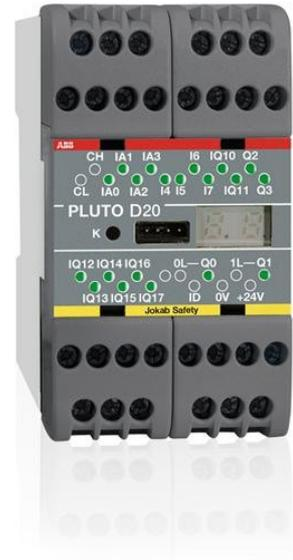
AUTOMATE de sécurité avec Pluton bus de sécurité et les entrées analogiques. Totallement 20 I/O: 4 combinés failsafe entrées analogiques et digitales, + 4 entrées de sécurité + 8 non-failsafe des sorties/entrées de sécurité + 2 individuellement failsafe des sorties relais + 2 individuellement failsafe sorties à transistor. Entrée analogique 0-10V/4-20mA.
