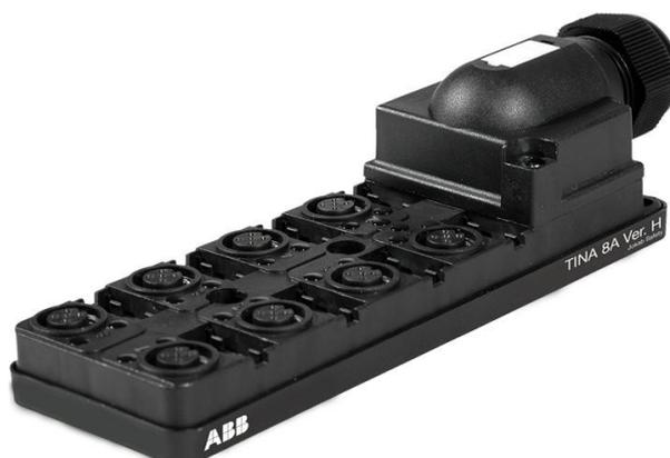
Bloc de connexion avec l'adaptation de l'unité de dynamique des circuits. Huit M12 5 pôles connecteurs pour l'entrée du capteur. Chacun des capteurs d'informations d'état peuvent être installés séparément. Câble de connexion de la gamme de diamètres: de 7 à 12 mm.
