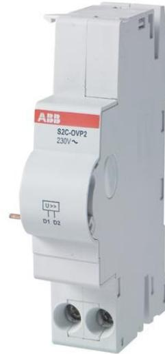
Le S2C-OVP1 surtension de sortie ' a la fonction de surveillance de la tension entre le neutre et la phase lorsqu'une surtension atteint la valeur de seuil, l'OVP provoque le déclenchement de l'appareil associé. Adapté pour S200 Disjoncteurs jusqu'à 63A, F200, Dessins ou modèles communautaires enregistrés jusqu'à 100A et DS201-DS202C Disjoncteurs. Max de déclenchement de tension: 275V un.c.
