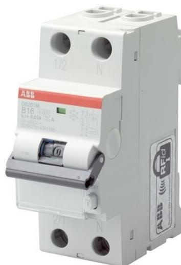
Le DS201 série RCBO est un 1P+N dans les deux modules de l'appareil pour la protection de l'utilisateur final une seule phase de circuits contre les surcharges et les courants de courts-circuits; protection contre les effets de la sinusoïdal alternatif de défaut à la terre les courants; la protection contre les contacts indirects et de la protection complémentaire contre les contacts directs (avec une sensibilité = 30 mA).
