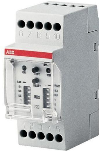
Courant résiduel moniteurs (Gcr) avec transformateur externe peut détecter les courants de fuite. Par minidip vous pouvez régler la sensibilité et le temps d'intervention. Tension de fonctionnement: 230...400 V un.c.
