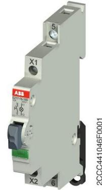
Bouton-poussoir 1 NO / 1 NC sans entretien LED, le courant Nominal: 16A/250 VACPDC, de la couleur des LED: vert, 115-250 VACPDC, de 12 à 48 VACDCPDC, 110-220 VDCPDC, largeur de Module 0,5
