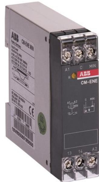
Niveau de liquide de relais CM-ENE MIN largeur de 22,5 mm, protection contre le fonctionnement à sec, la sensibilité 0-100kOhm fixe, A1-A2=24VAC, 1 n/o (ouvrir principe du circuit)
