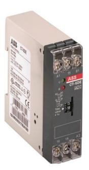
Le CT-SDE est une fonction unique électronique relais temporisé de la CT-E minuteur de gamme. Il fournit une étoile-triangle fonction avec un intervalle de temps à partir de 0,3 s à 30 s. Cette fois, le relais fonctionne avec une puissance de contrôle de la tension d'alimentation 220 - 240 V AC et a 1 n/o + 1 n/c de sortie avec contacts évalué à 250 V / 4 A.
