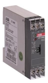
Le CT-VWE est une fonction unique électronique relais temporisé de la CT-E minuteur de gamme. Il fournit une impulsion (intervalle) fonction avec un intervalle de temps de 3 s à 300 s. Cette fois, le relais fonctionne avec une puissance de contrôle de la tension d'alimentation 110 - 130 V AC et a 1 c/s (INVERSEUR) sortie nominale 250 V / 4 A.
